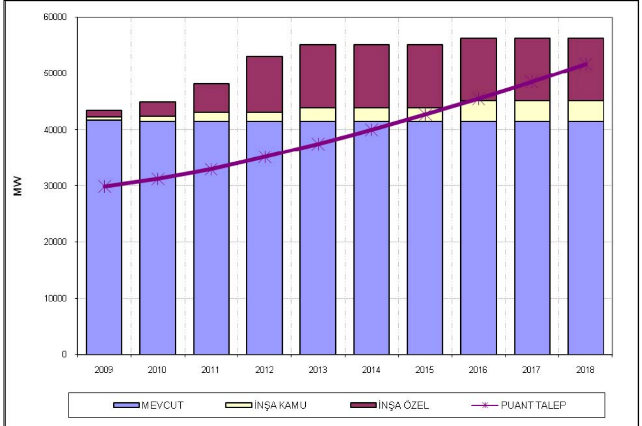
Grafik 23: Mevcut, İnşası Devam Eden Kamu ve Özel Sektör Üretim Tesislerinin Kurulu Gücün Gelişimine ve Puant Güç Talebinin Karşılanmasına Etkisi (Çözüm II - A)
