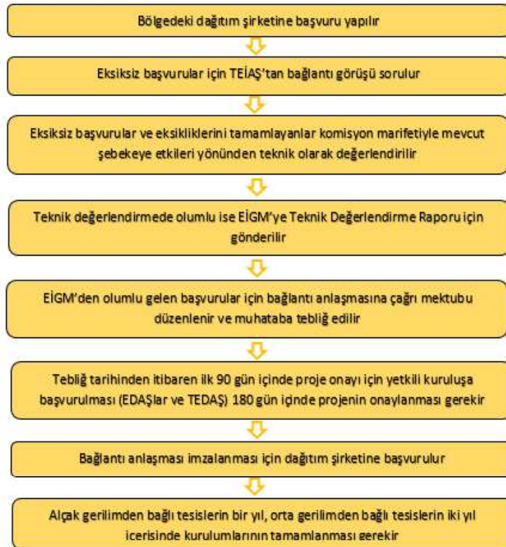
Şekil 1.5: Lisanssız GES Projesinin Kurulum Süreci 87
